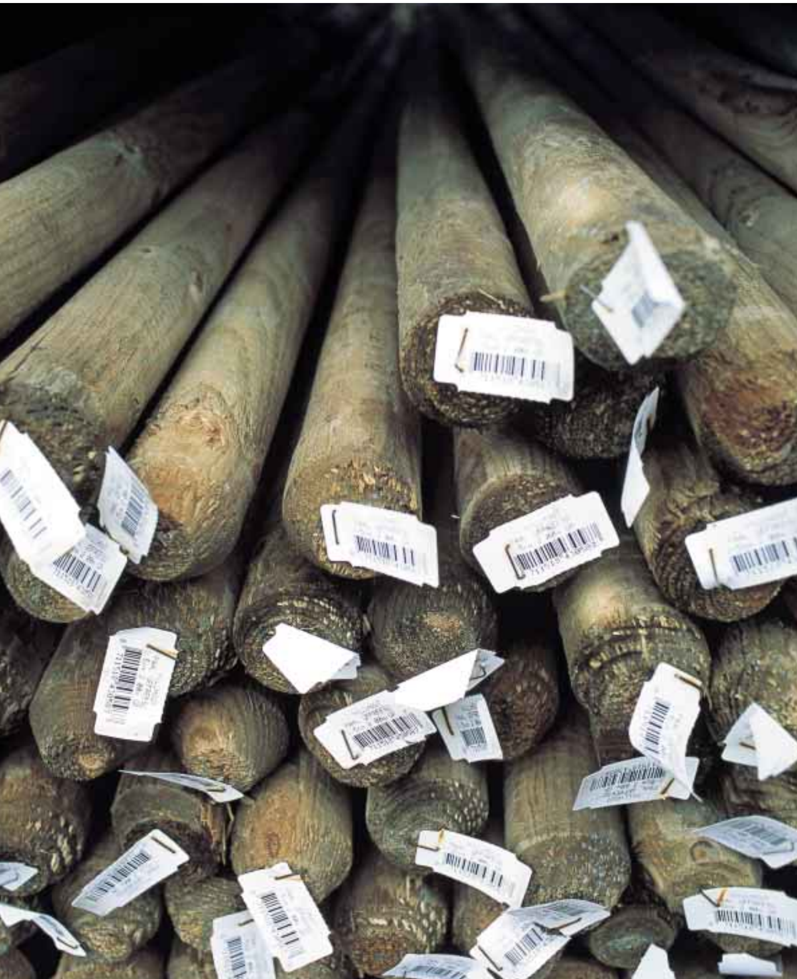
Hout, verduurzaamd met koperchromarseenverbinding
